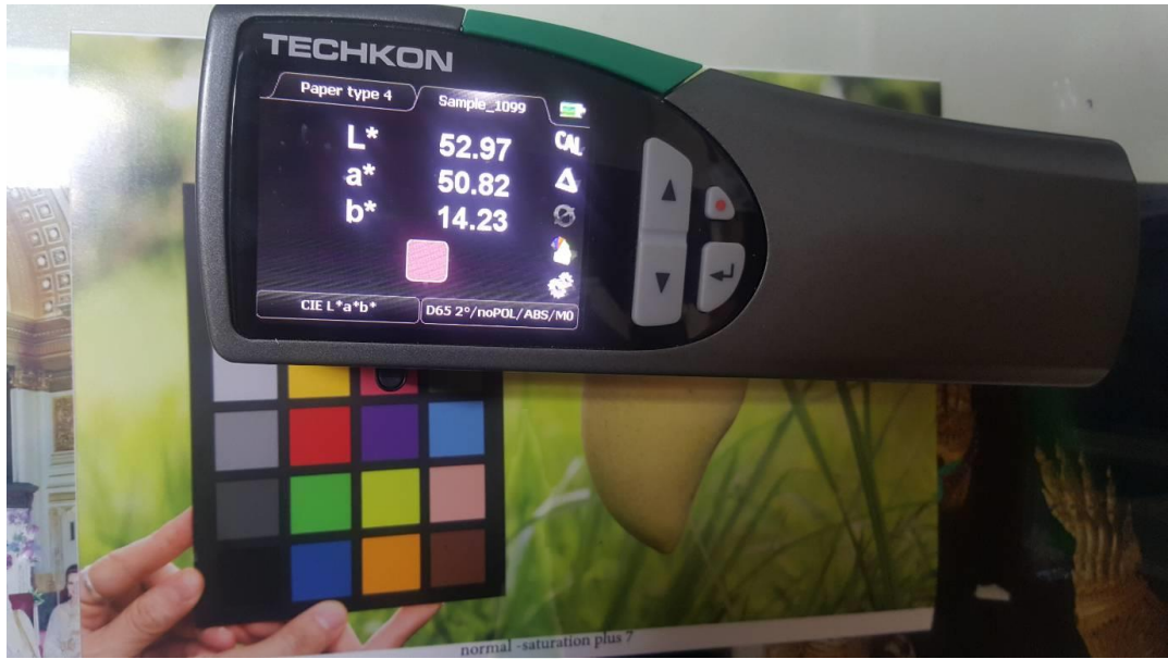
ภาพที่ 3.7 ตัวอย่างการวัดค่าสี CIELAB ของแผ่นทดสอบสี ด้วย Techkon Spectrophotometer
